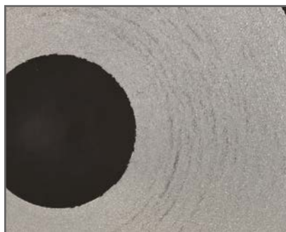
Kąt przystawienia 6° – Rz 11.3 μm
